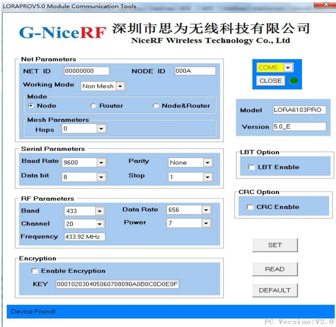
**注：**此模块为大功率模块，如用转接板连接 PC 端串口收发数据需要额外给模块提供电源。
